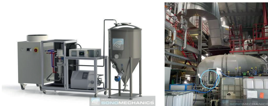
Rys. 42. Linia do ekstrakcji ultradźwiękowej firmy Industrial Sonomechanics ( https://www.sonomechanics.com )
