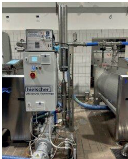
Rys. 39. Sonikator UIP6000hdT firmy Hielscher Ultrasonics GmbH (©2024 www.hielscher.com ) w instalacji przemysłowej do ekstrakcji ciągłej
