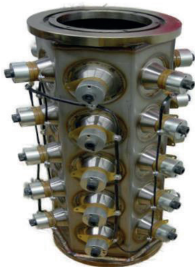
Rys. 22. Reaktor przepływowy firmy KLN Ultraschall AG ( https://kln.de )
