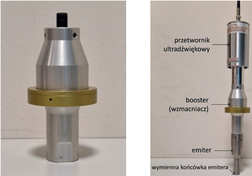
Rys. 29. Wzmacniacze firmy Sonics and Materials: a) pojedynczy element, b) zmontowany z przetwornikiem i emiterem (opracowanie własne)
