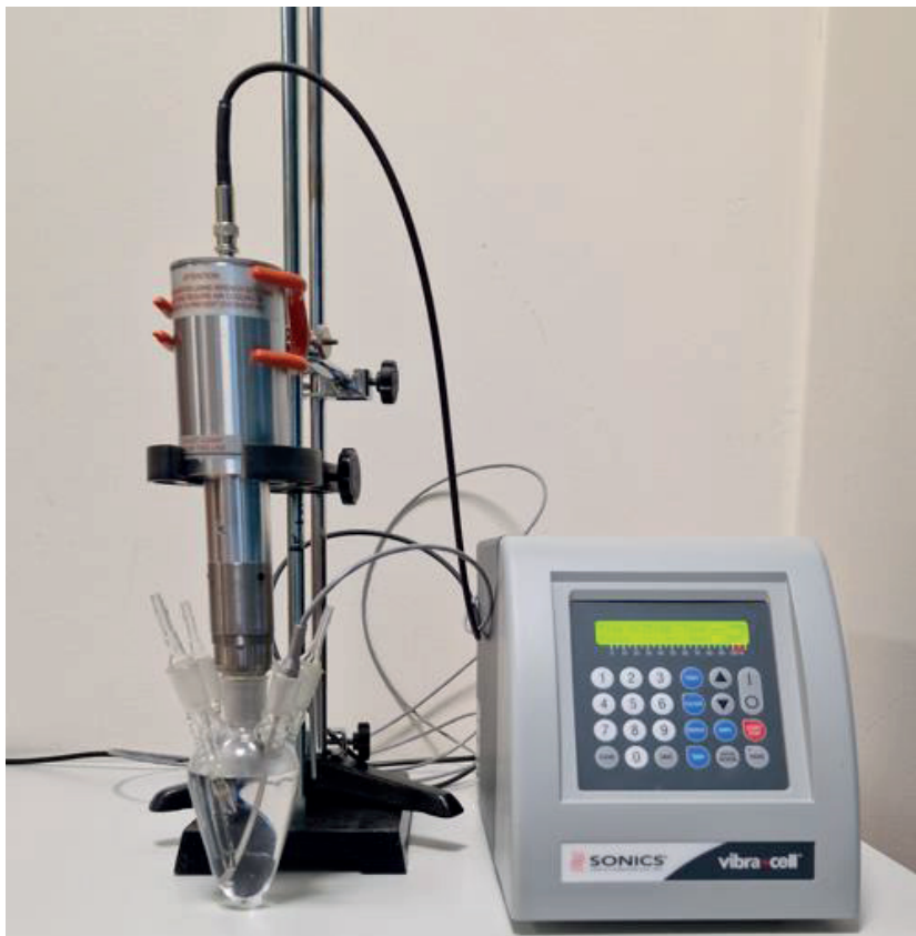
Rys. 34. Stanowisko do ekstrakcji ultradźwiękowej z naczyniem ekstrakcyjnym w kształcie kolby sercowej -układ bez chłodzenia (opracowanie własne)
