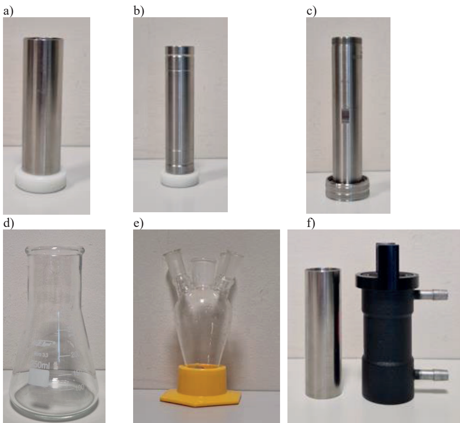
Rys. 36. Kształty naczyń używanych do badania procesu ekstrakcji ultradźwiękowej: a) cylinder o średnicy 30 mm i wysokości 100 mm, b) cylinder o średnicy 30 mm i wysokości 130 mm, c) cylinder o średnicy 30 mm i wysokości 160 mm, d) kolba stożkowa, e) kolba sercowa, f) cylinder z płaszczem termostatującym (opracowanie własne)
