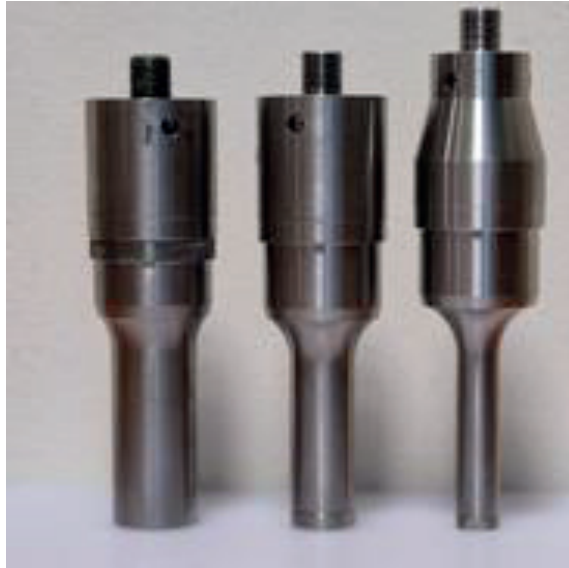
Rys. 11. Emitery firmy Sonics and Materials o różnych średnicach (opracowanie własne)
