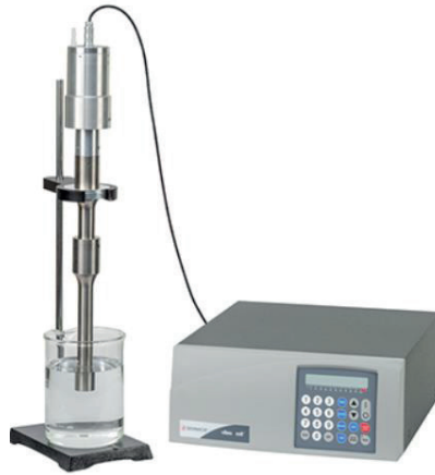
Rys. 43. Procesor ultradźwiękowy VCX 1500 firmy Sonics and Materials. Model o mocy 1500 W wyposażony w sondę o średnicy 1 cala i długości 10 cali, pracującą z maksymalną amplitudą drgań 100 \mu\text{m} ( https://www.sonics.com )
