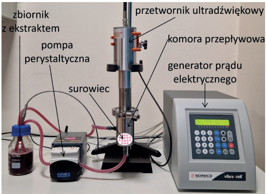
Rys. 38. Stanowisko do ekstrakcji ultradźwiękowej w układzie przepływowym (opracowanie własne)
