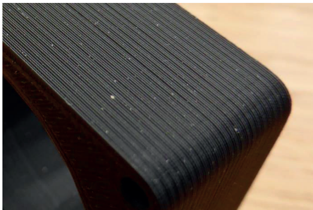
Rys. 49. Nierówna powierzchnia elementu występująca podczas druku 3D w technologii FDM/FFF ( https://wikifactory.com/... )
