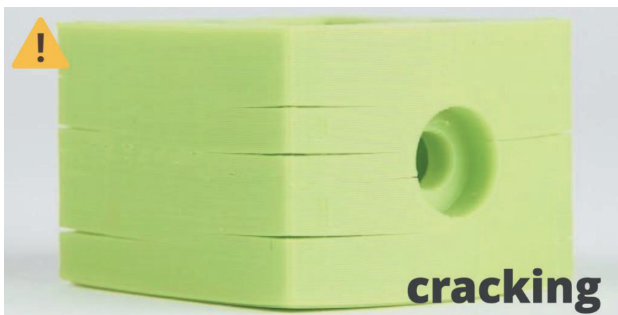
Rys. 47. Pękanie elementów (rozwarstwianie) podczas druku 3D w technologii FDM/FFF ( https://wikifactory.com/... )
