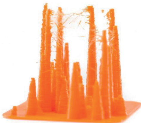
Rys. 50. Nitkowanie występujące podczas druku 3D w technologii FDM/FFF ( https://wikifactory.com/... )
