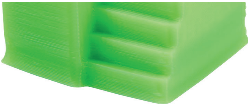
Rys. 52. „Stopa słonia” występująca podczas druku 3D w technologii FDM/FFF ( https://wikifactory.com/... )
