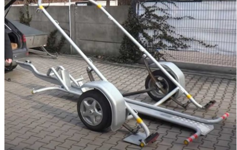
Rys. 4. Bardzo lekka konstrukcja umożliwiająca podnoszenie rampy wraz z załadunkiem za pomocą siły rąk
