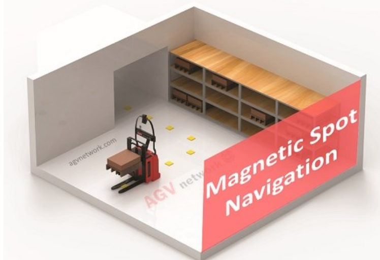
Rys. 6. Zasada działania nawigacji pojazdu AGV z wykorzystaniem punktów magnetycznych
