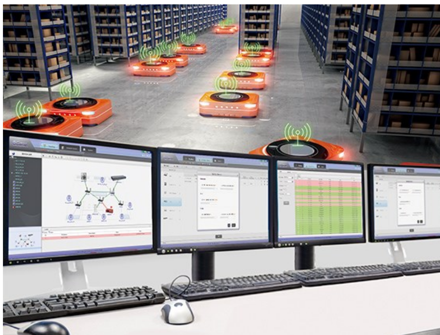
Rys. 12. System sterowania i nadzoru nad bezpieczeństwem floty pojazdów AGV realizowany jest poprzez wykorzystanie przemysłowej sieci Wi-Fi
