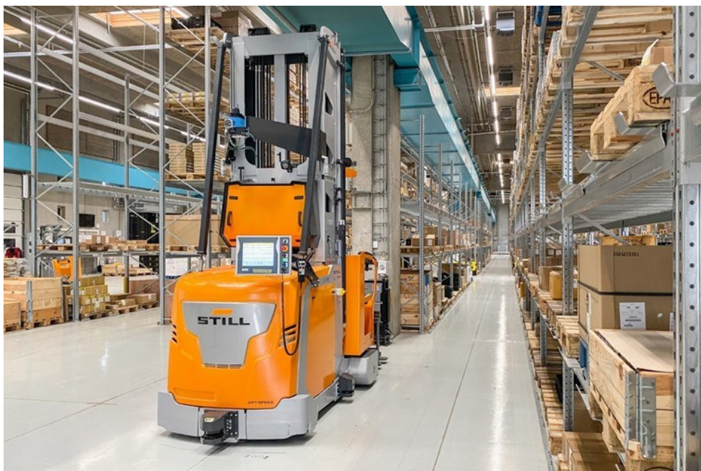
Rys. 8. Automatyzacja prac na magazynie z wykorzystaniem pojazdów widłowych AGV firmy STILL
