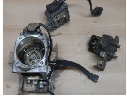
Rys. 5. Pompa wtryskowa ze zdemontowanym tłokorozdzielaczem
