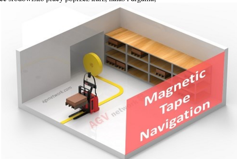
Rys. 4. Zasada działania nawigacji pojazdu AGV z wykorzystaniem taśmy magnetycznej na powierzchni transportowej
