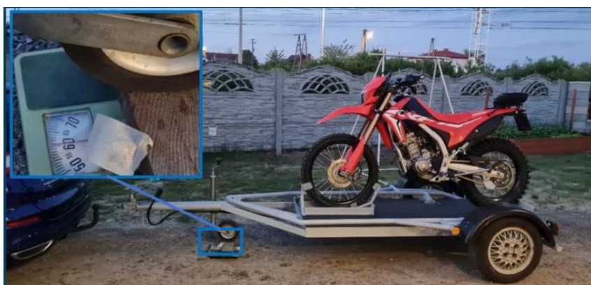
Rys. 32. Przyczepa z ładunkiem. Pomiar obciążenia haka samochodu
