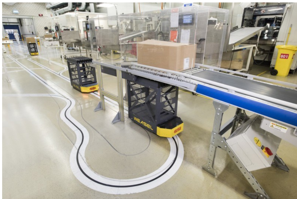
Rys. 9. Ekonomiczny zautomatyzowany transport AGV pojazdami SSI SCHAEFER WEASEL® w firmie Bachmann Forming
