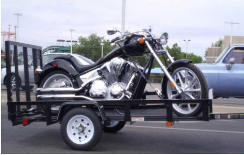
Rys. 3. Uniwersalna przyczepa bez możliwości opuszczania platformy transportowej oraz motocykl o bardzo małym prześwicie
