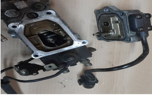
Rys. 4. Pompa wtryskowa po demontażu nastawnika
