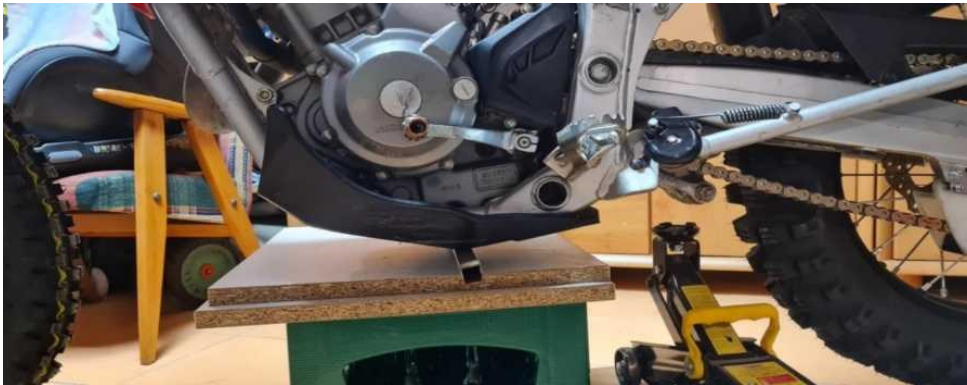
Rys. 10. Sposób wyznaczenia środka ciężkości motocykla
