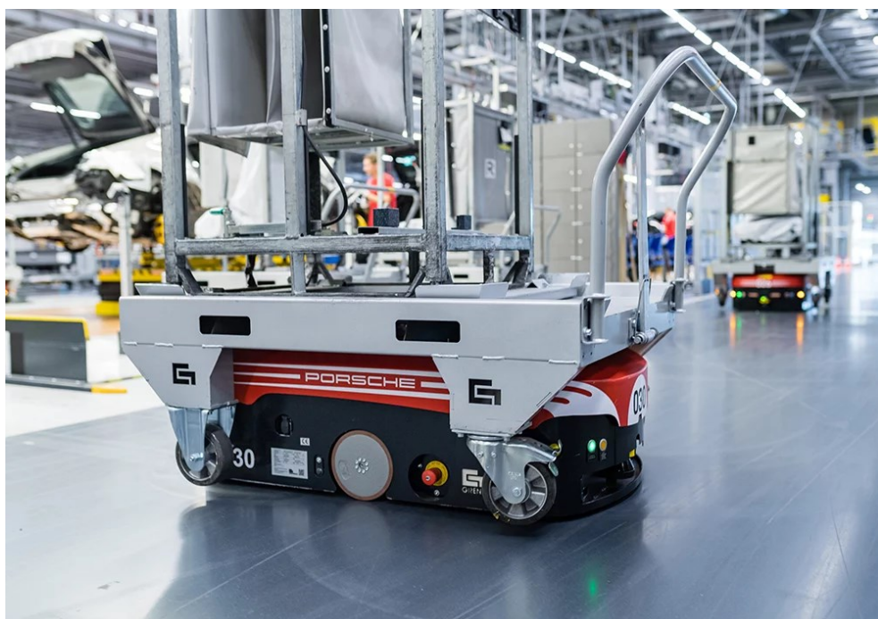
Rys. 10. Pojazdy Grenzbach L1200S AGV do automatycznego transportu części podczas złożonej produkcji sekwencyjnej modeli Macan i Panamera w fabryce Porsche w Lipsku
