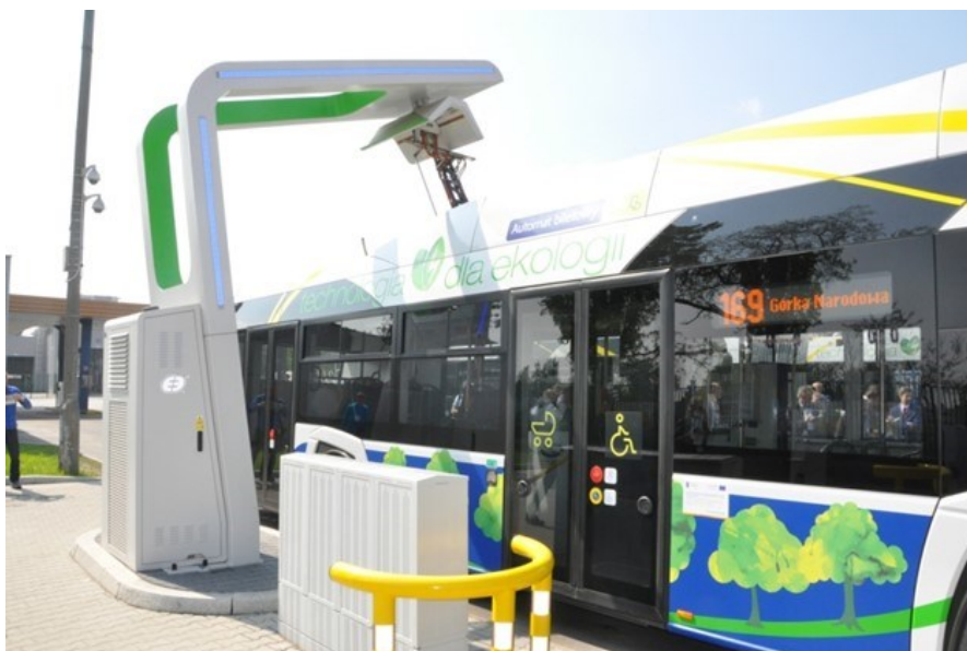
Rys. 11. Stacja szybkiego ładowania autobus elektrycznego marki Solaris w Krakowie za pomocą pantografu na przystanku krańcowym linii
