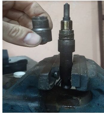
Rys. 9. Wtryskiwacz z odkręconą nakrętką rozpylacza
