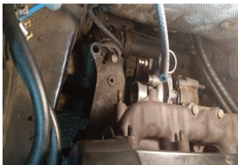
Rys. 12. Garrett GT1549 podczas montażu
