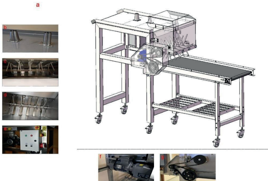
Rysunek 4. Prototyp kruszarki do warzyw: a – ogólny widok urządzenia; b – noże do różyczkowania; c – komora rozdrabniania; d – ruszt komory rozdrabniania; e – skrzynka sterownicza; f – silnik elektryczny; g – przekładnie pasowo-klinowe.
