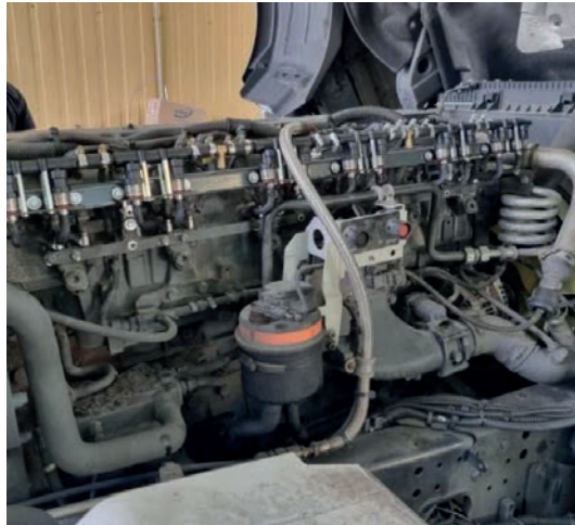
Rysunek 4. Montaż wtryskiwaczy gazu do silnika PACCAR MX-13
