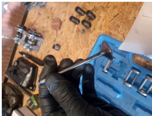
Rysunek 12. Zawór z uszkodzoną przylgnią
