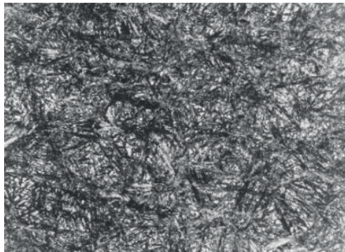
Rysunek 4. Struktura metalograficzna materiału uszkodzonego koła
