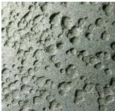
Rysunek 15. Widok pod mikroskopem zużytej powierzchni walców
