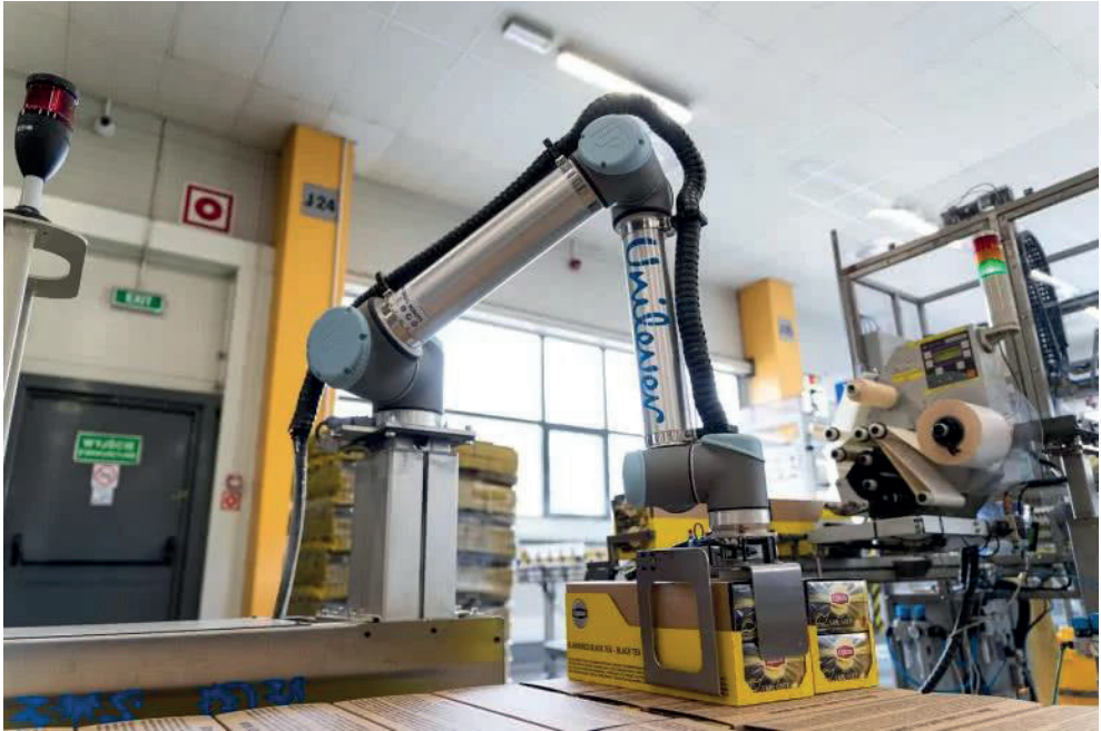
Rysunek 5. Proces układania pudełek herbaty przez robota współpracującego UR10 w fabryce koncernu Unilever
