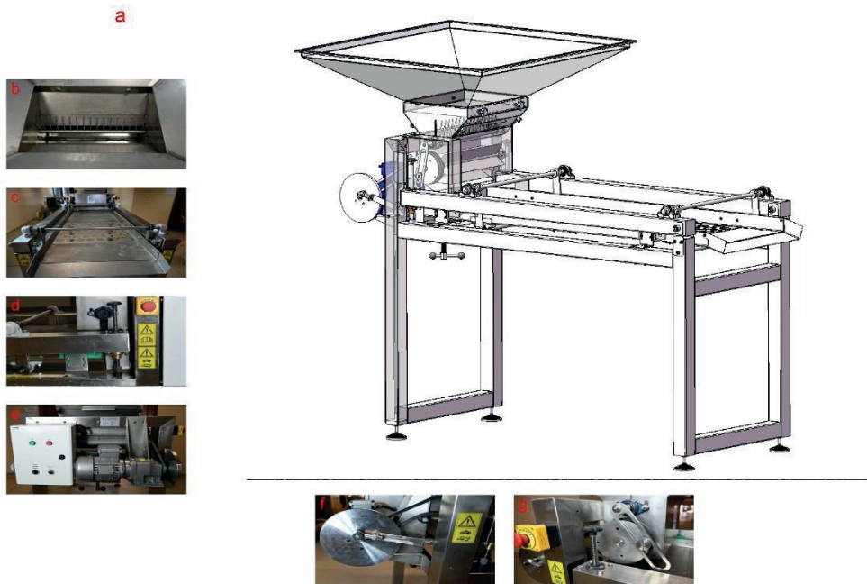
Rysunek 6. Prototyp kalibratora do warzyw: a – ogólny widok urządzenia; b – zbiornik zasypowy z mieszadłem i dozownikiem; c – kosz sitowy; d – mechanizm zmiany kąta ustawienia kosza sitowego oraz płytki ślizgowej; e – skrzynka sterownicza i silnik elektryczny; f – mechanizm napędu kosza sitowego; g – mechanizm napędu mieszadła
