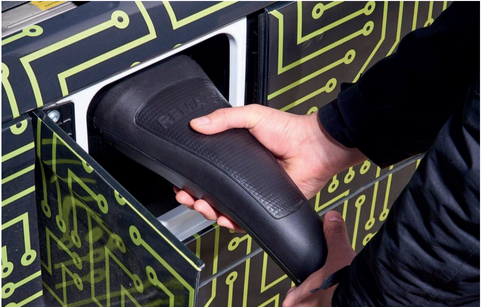
Rysunek 8. Nowy standard ładowania dla ciągników siodłowych MCS testowany przez koncern Mercedes dla modelu eActros 600, ilustrujący wielkość złącza zasilającego o mocy 1 MW
