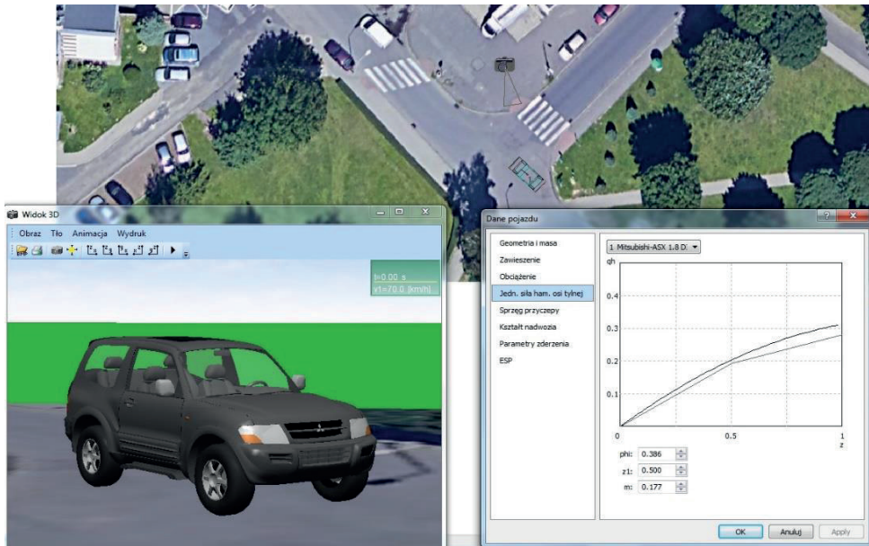
Rysunek 4. Dane pojazdu – jednostkowa siła hamowania osi tylnej Mitsubishi ASX
