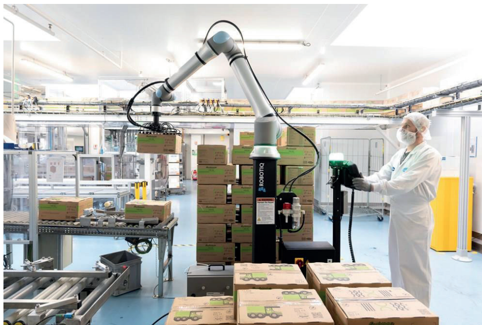
Rysunek 6. Cobot UR20-PE20 oferowany na rynku przez firmy Universal Robots i Robotiq do paletyzacji produktów na magazynie o udźwigu 20 kg i zasięgu 2150 mm
