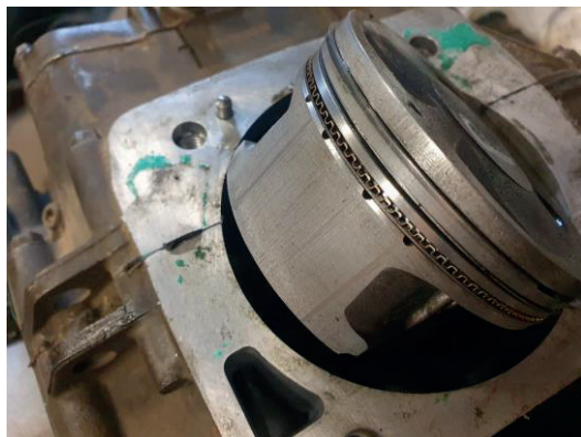
Rysunek 17. Tłok silnik czterosuwowego zatarty w cylindrze
