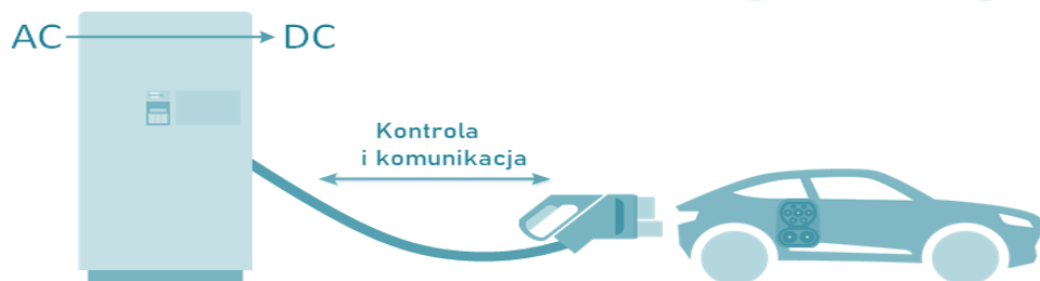
Rysunek 4. Schemat przedstawiający tryb ładowania Mode 4
