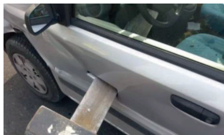
Rysunek 11. Skutki kolizji koparko-ładowarki z samochodem osobowym (przypadek 11)
