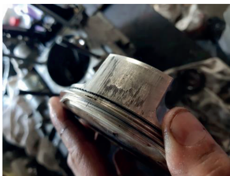
Rysunek 18. Zatarty tłok silnika motocykla Kawasaki KXF 250
