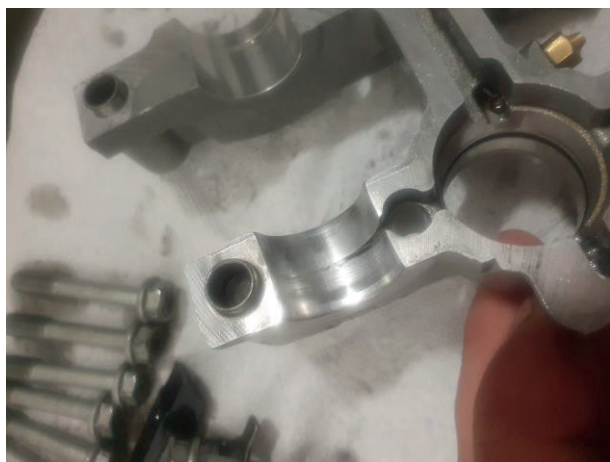
Rysunek 22. Pęknięta panewka głowicy silnika KTM SXF 250
