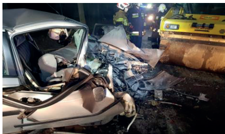
Rysunek 10. Skutki zderzenia samochodu osobowego z walcem drogowym (ograniczona widoczność, noc) (przypadek 6)
