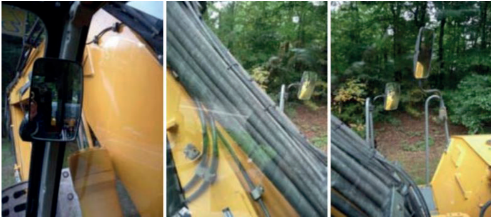
Rysunek 7. Ograniczony bezpośredni widok operatora z prawej strony koparki
