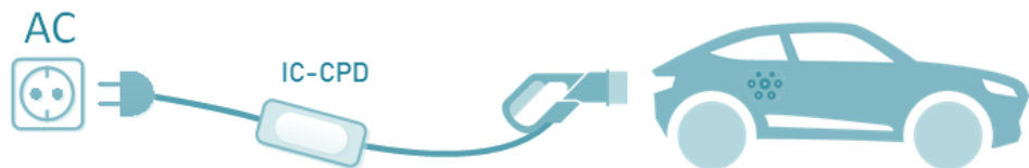
Rysunek 2. Schemat przedstawiający tryb ładowania Mode 2
