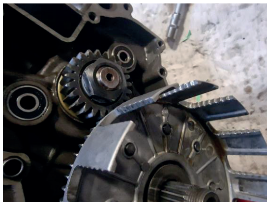
Rysunek 2. Zużycie ściernie powierzchni kosza sprzęgłowego
