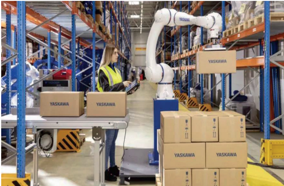
Rysunek 3. Proces układania ładunków na paletcie realizowany przez cobota serii HC firmy Yaskawa
