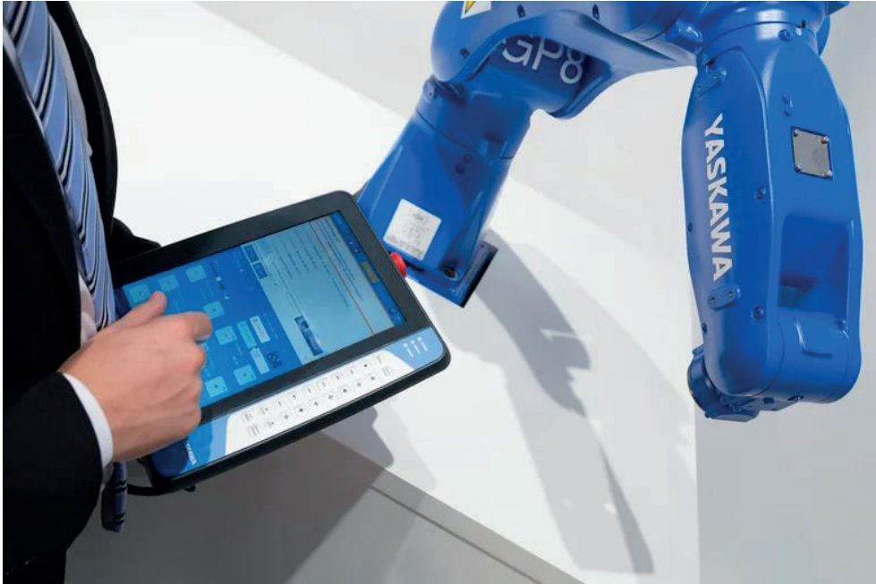
Rysunek 4. Innowacyjny programator robotów i cobotów Smart Pendant opracowany przez YASKAWA Electric Corporation
