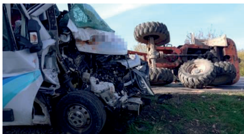
Rysunek 12. Skutki uderzenia samochodu dostawczego w łożówkę (przypadek 13)
