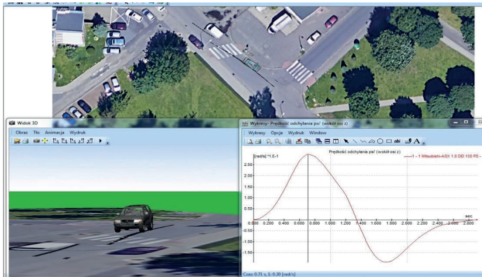
Rysunek 14. Prędkość odchylenia psi' (wokół osi Z) dla v = 90 \text{ km}\cdot\text{h}^{-1} \text{ rad}\cdot\text{s}^{-1} = 0,71 dla t = 0,30 \text{ (s)}
