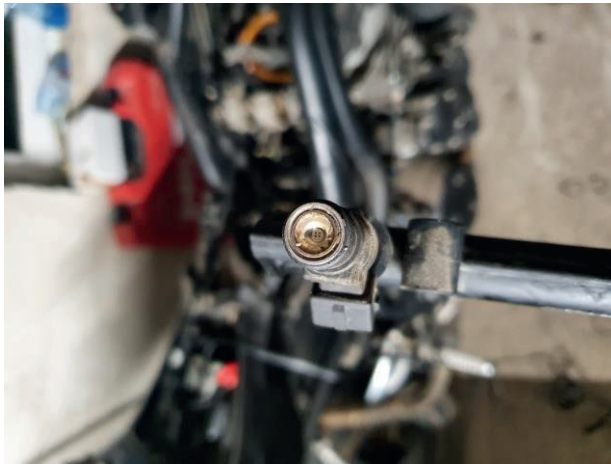
Rysunek 19. Wtryskiwacz paliwa zużyty erozyjnie
