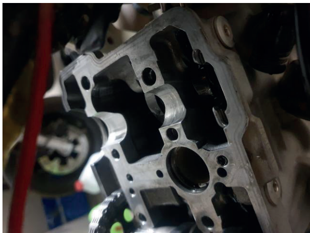
Rysunek 23. Szepianie II rodzaju pomiędzy czopem wałka rozrządu a panewką
