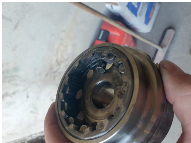
Rysunek 14. Uszkodzone sprzęgło jednokierunkowe KTM SXF 250
