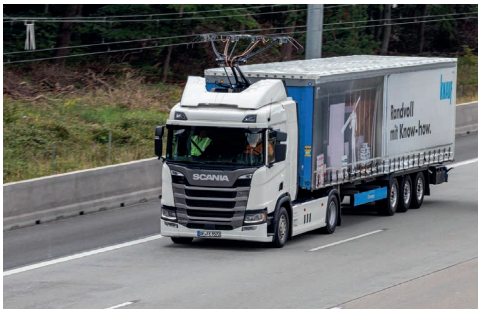
Rysunek 15. Pierwszy w Niemczech zelektryfikowany odcinek drogi testowany przez elektryczne ciągniki siodłowe Scania
