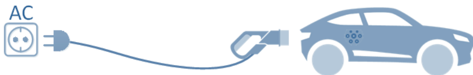
Rysunek 1. Schemat przedstawiający tryb ładowania Mode 1
