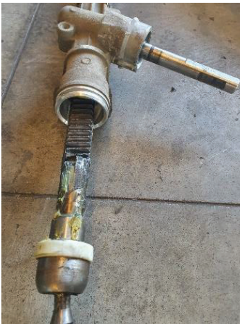
Rys. 13. Opel Meriva - Uszkodzona przekładnia kierownicza, nadmierny luz na listwie
