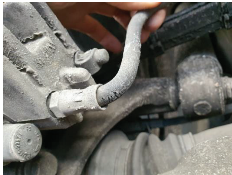
Rys. 11. BMW 5 – Uszkodzony przewód hamulcowy elastyczny
