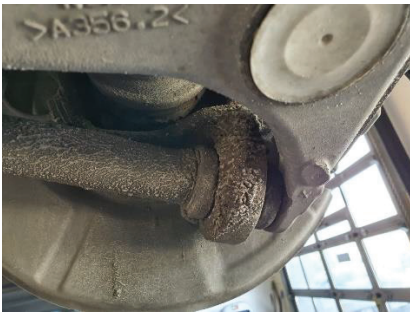
Rys. 5. BMW 5 - Uszkodzona tuleja pływająca tylnego zawieszenia
