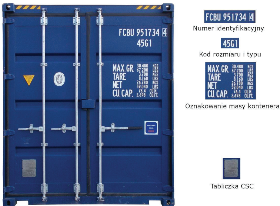
Rys. 2. Najważniejsze informacje dotyczące danej jednostki umieszczone są na drzwiach kontenera
