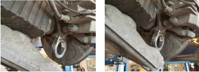
Rys. 9. BMW 5 – Zawieszenie po zdemontowaniu tulei
