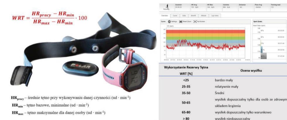
Rys. 3. Urządzenie do pomiaru liczby uderzeń serca oraz sposób oceny wysiłku fizycznego na podstawie wskaźnika rezerwy tętna
