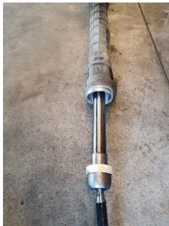
Rys. 15. Opel Meriva – ślady intensywnego zużycia ściernego
