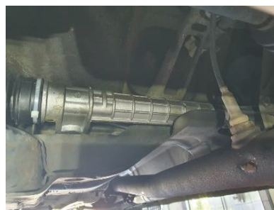
Rys. 19. Opel Meriva – Zamontowana przekładnia kierownicza przed ustawianiem geometrii zawieszenia
