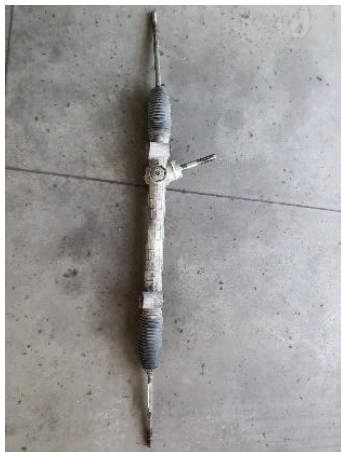
Rys. 15. Opel Meriva - Zdemontowana uszkodzona przekładnia kierownicza
