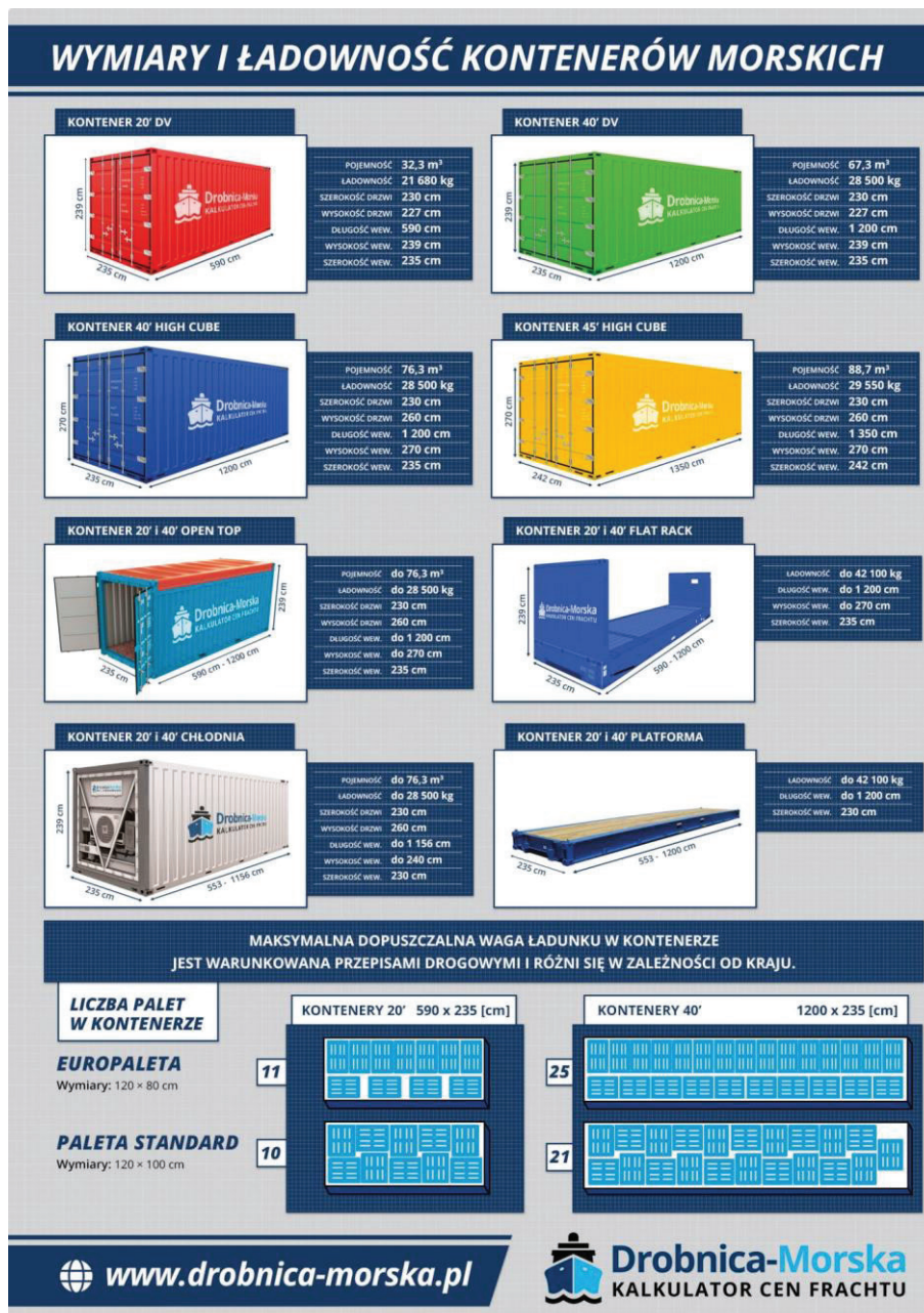
Rys. 1. Wymiary i ładowność poszczególnych rodzajów kontenerów morskich 20 i 40 stopowych oraz zalecane metody załadunku w nich palet standardowych i europalet
