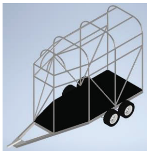
Rys. 18. Konstrukcja ramowa ścian przyczepy
