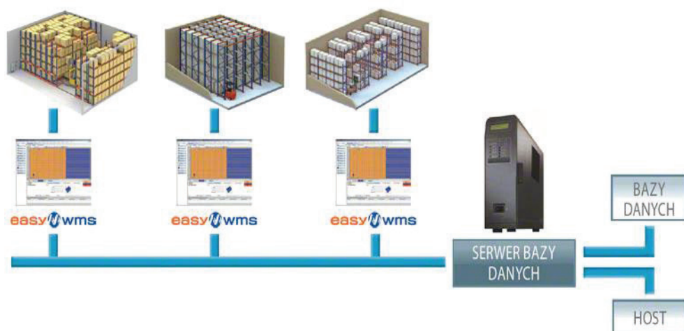
Rys. 3. Schemat struktury funkcjonowania oprogramowania WMS, opracowany przez firmę MECALUX SA dla zarządzania procesami w kilku magazynach
