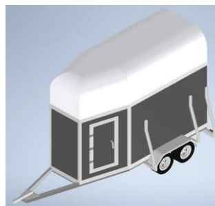
Rys. 23. Przyczepa do przewozu koni – kompletne złożenie
