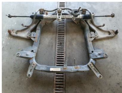
Rys. 17. Opel Meriva - Zamontowana nowa przekładnia kierownicza na ramie pośredniej
