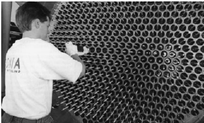
Rys. 15. Wysokowydajny generator ozonu (Ozonía Ltd.; Kogelschatz i in., 1999)
