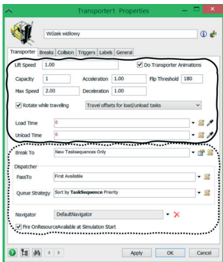
Rys. 19. Właściwości obiektu Transporter1 (Wózek widłowy)
