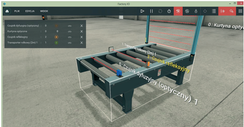
Rys. 18. Transporter rolkowy z wybranymi czujnikami detekcyjnymi
