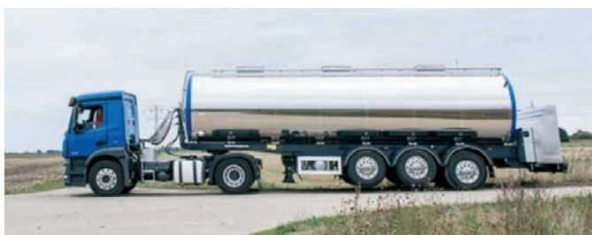
Rys. 5. Cysterny do przewożenia paliwa i mleka (odbijająca powierzchnia cysterny do przewożenia mleka ogranicza jej nagrzewanie się od promieniowania słonecznego, a zatem i wzrost temperatury mleka schłodzonego u producenta).
