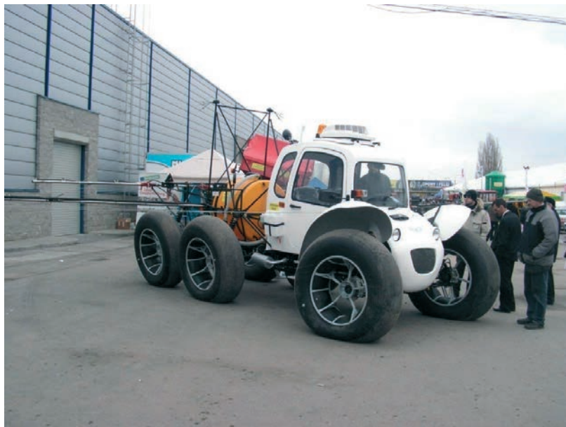
Rys. 10. Opony ciągnika do pracy na terenach bagiennych.
