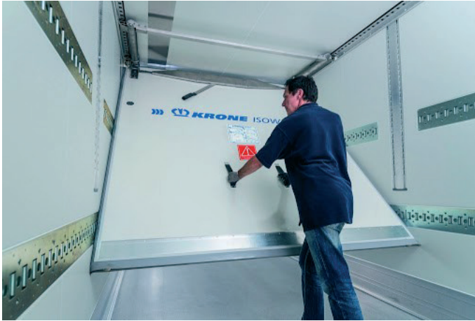
Rys. 4. Ściana działowa Krone Isowall Plus do naczep Cool Liner
