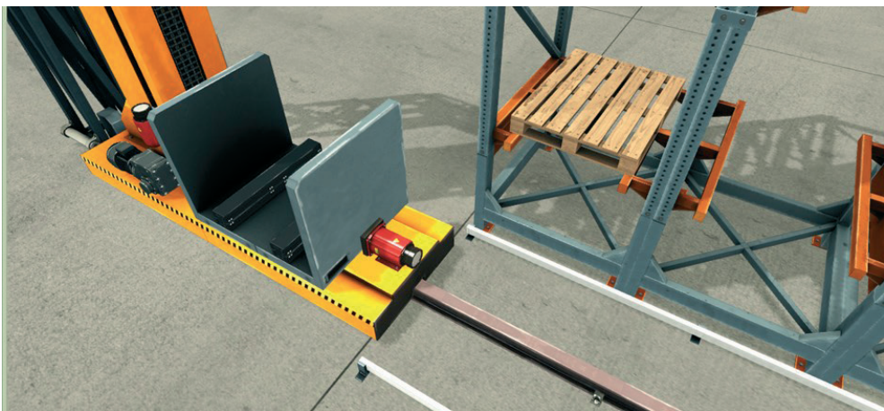
Rys. 13. Pozycja bazowa wózka układnicy magazynowej
