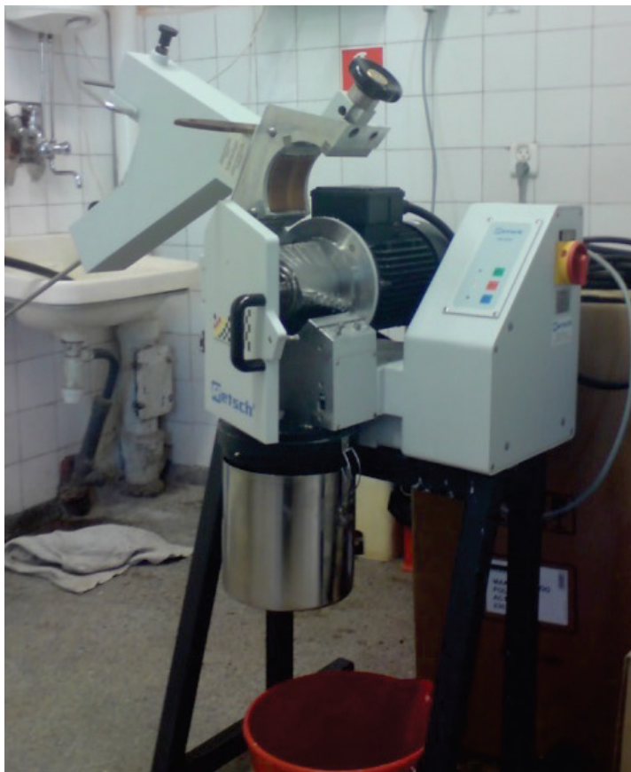
Rysunek 3. Młynek do mielenia biomasy Retsch SM 2000
