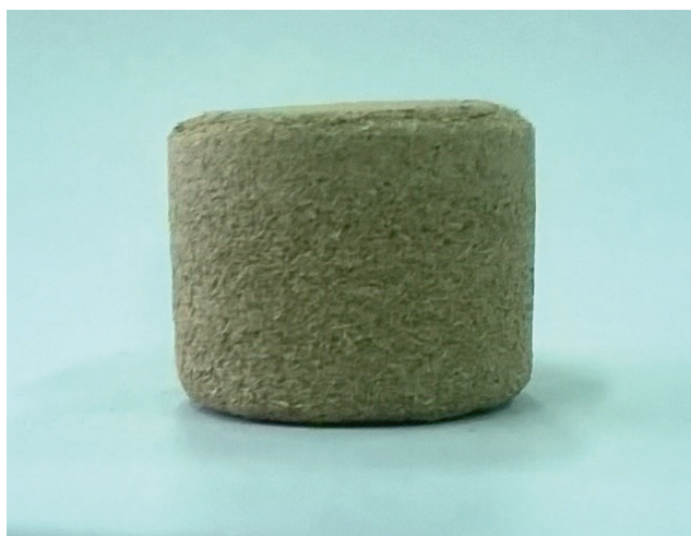
Rys. 4.12. Granula po teście wytrzymałości z widocznymi strefami w których następuje okruszanie
