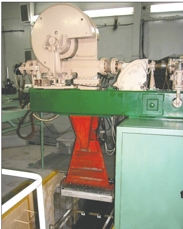
Rysunek 3. Widok urządzenia do utrwalania promieniowaniem jonizującym. Głowica kieruje odchyloną wiązkę promieni z akceleratora na pojemniki znajdujący się poniżej na podajniku rolkowym
