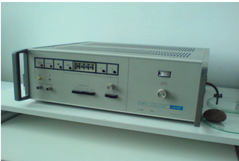
Rysunek 49. Generator sygnałów wysokiej częstotliwości G4-141 (moc wyjściowa 0-20 mW, częstotliwość = 37,5-54,55 GHz)
