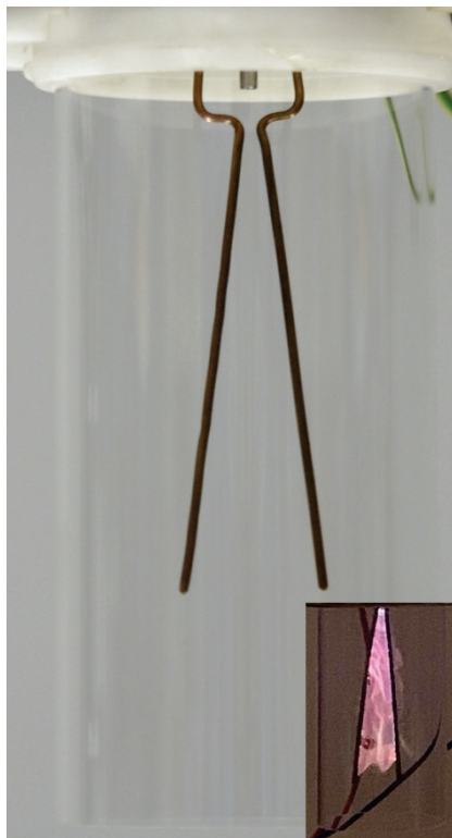
Rys. 3. Fotografia elektrod oraz wyładowania elektrycznego
